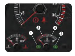
◆在通常情况下,气压表显示气压较低回路的压力值。通过仪表板下方的气压切换按键可以显示另一气压较高回路的气压值,10 秒钟之后会自动切换显示为气压较低回路的压力值。
