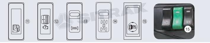
⑪ **节油开关**:按下开关,可以根据车辆配置自动确定最高行驶车速,发动机运行更为柔和,使车辆最大限度地行驶在经济条件下。
