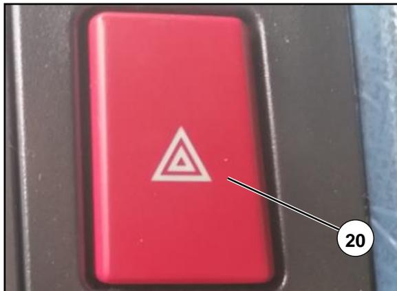
20 危急报警开关（左置车）：按下开关，所有转向灯均闪烁，仪表上的转向指示灯同时闪烁。
