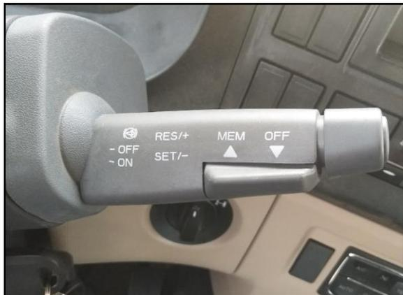
驾驶员可以通过上抬右组合开关设定加按键（RES+）或者向下压右组合开关设定减按键（SET-）设定巡航车速，从而使车辆进入巡航模式；当驾驶员松开油门踏板时，车辆会按照设定好的巡航车速行驶。
