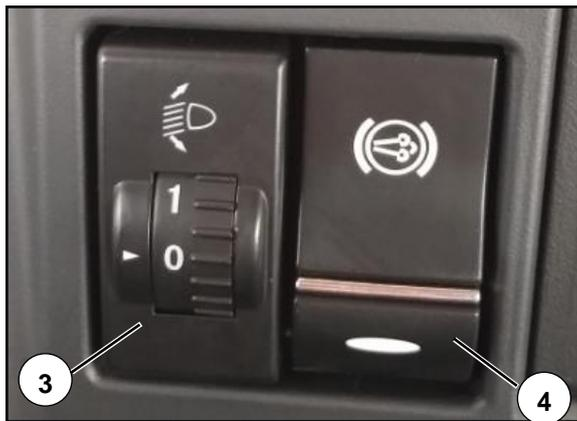
3 大灯光束调节开关：该开关功能为调节近光灯光束高度，此开关为滚轮式，设有0、1、2、3挡，工作时指示的挡位数字变成绿色，其中0挡为初始挡位，且为光束最高位置，随着挡位的增加，大灯高度逐级下降。
