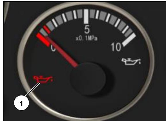
发动机启动时，驾驶员显示屏不能出现下列任何一种显示：“机油压力报警”信息。
