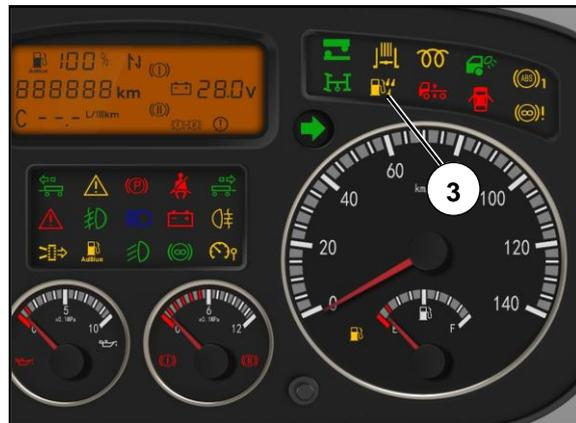
按水位传感器报警提示排除燃油粗滤器内的杂质和水。
