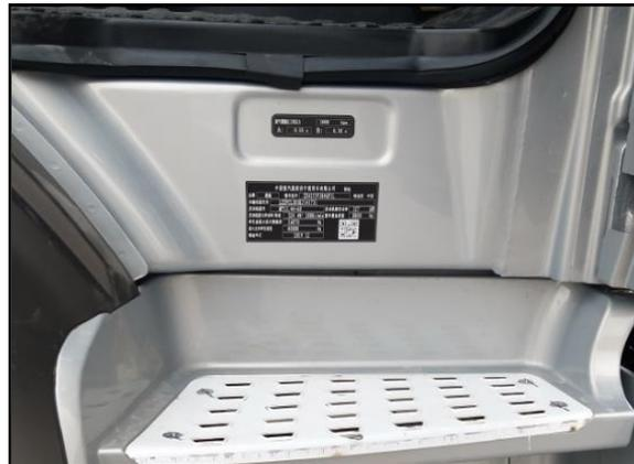
VIN 位于前轴中心线处的车架右纵梁腹板外侧及车辆铭牌上。
